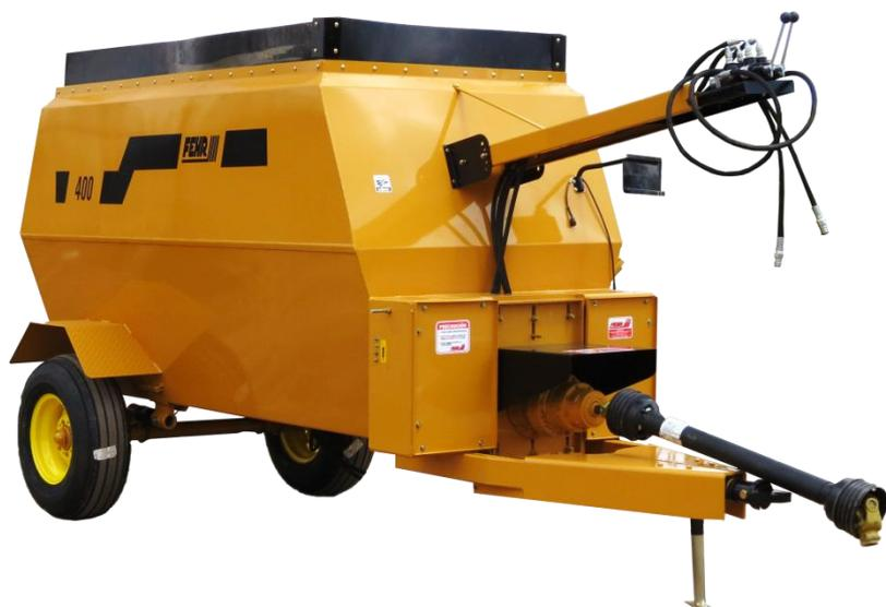
El sistema utilizado es hidráulico, el aceite que se usa es el mismo del tractor, además consta de un motor hidráulico que hace girar la banda de descarga.
